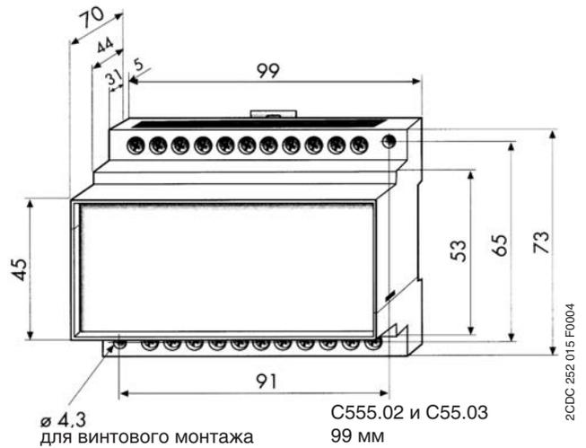
Реле контроля температуры, типоряд C51x
