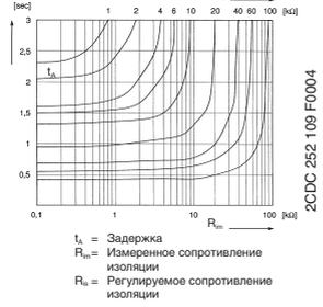
Прибор **CM-IWN-AC** применяется для контроля сопротивления изоляции одно- или трехфазных сетей переменного тока. Основная область применения - контроль вторичных цепей, электрически изолированных от земли. CM-IWN-AC контролирует сопротивление изоляции между незаземленными сетями переменного тока и защитным заземляющим проводом. Измерение производится с помощью наложенного измерительного напряжения постоянного тока.
